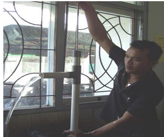
Gambar 4 desain pompa dari pipa PVC dan hasil pembuatannya
