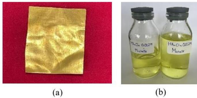
**Gambar 1.** Au foil (a) dan Larutan  $\text{HAuCl}_4$  0,002 M (b)
