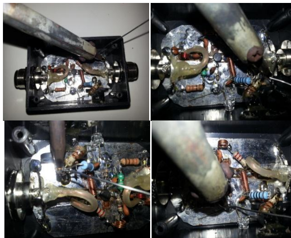
Gambar 18 Penyolderan Komponen Booster
