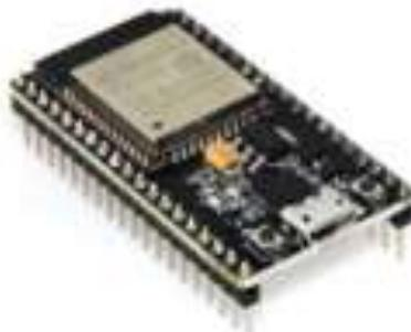
Gambar 3. *Mikrokontroler* ESP32
