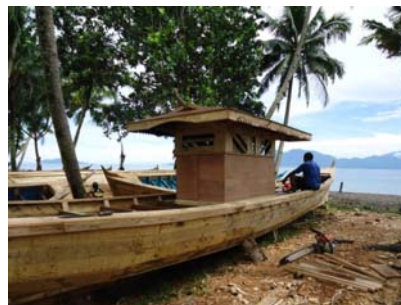
(sumber : foto pribadi, 2012) Gambar 32 Pembuatan perahu Kora-kora model Juanga
