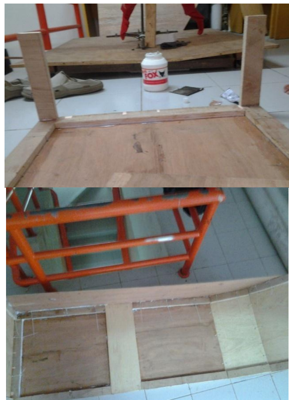
Gambar 7 Tahap 2 Pembuatan Kontruksi dan Bulkhead
