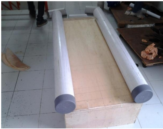
Gambar 8 Tahap 3 Pembuatan Kontruksi Katamaran Menggunakan Pipa Plastik
