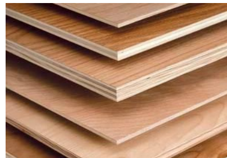
Gambar 1 Jenis-jenis Ketebalan Plywood
