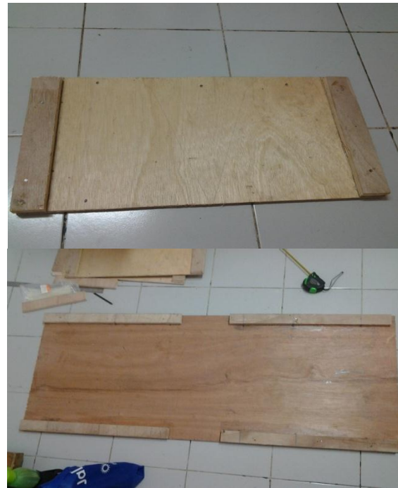
Gambar 6 Tahap 1 Pembuatan Dasar Perahu
