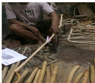
Gambar 5 proses pelengkungan rotan
