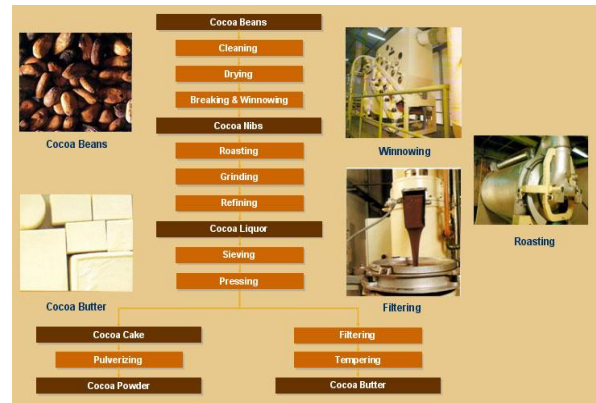
Gambar 2 Proses produksi cocoa powder
